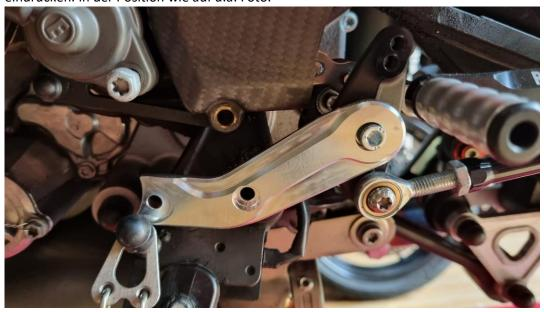
2. Den Supporter nach oben klappen, bis das vordere Loch des Supporters mit dem unteren/hinteren Loch des KNZ bündig ist und die original Schraube M6 x 55 durchgesteckt werden kann. Diese dann leicht andrehen.
